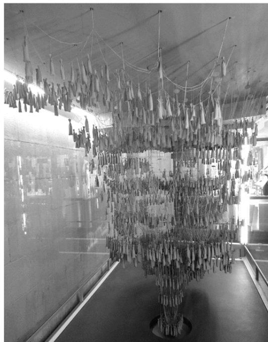
تصویر ۶. مدل کوچک مقیاس گائودی برای طراحی کلیسای ساگرادا فامیلیا،
