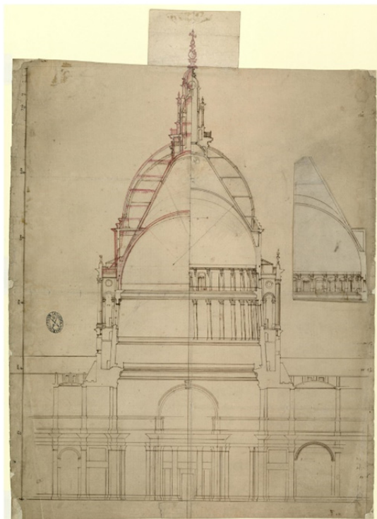
تصویر ۵. مقطع کلیسای جامع سنت پل در لندن. منبع سایت رسمی کلیسا
